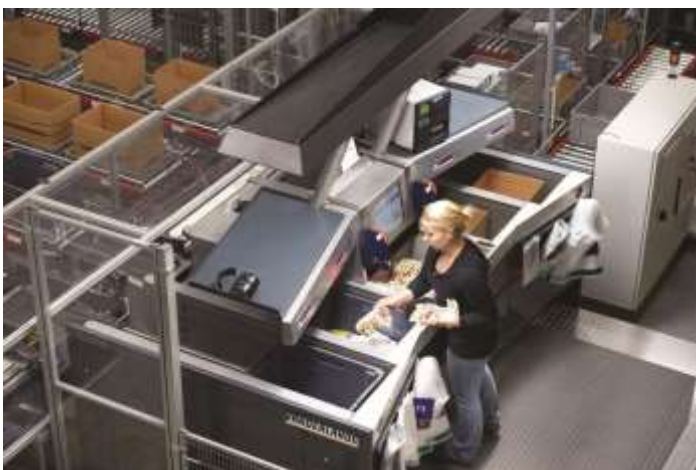
Die Kommissionierstation Pick@Ease von Vanderlande Industries ist leistungsfähig und besonders ergonomisch.
