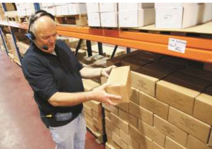
Beim sprachgestützten Kommissionieren mit Headset und Mobilcomputer Talkman sind beide Hände frei zum Zupacken.
