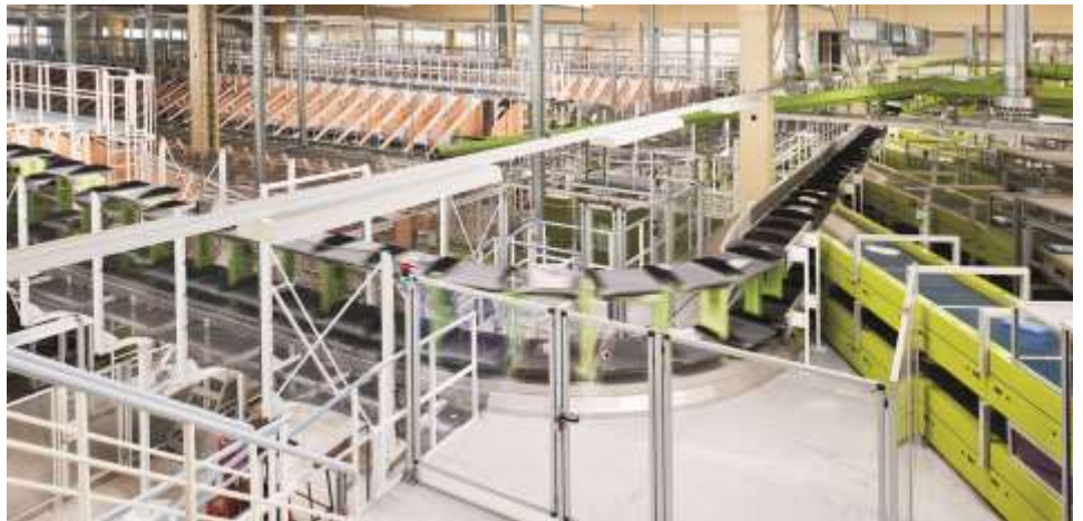
Die automatische Erfassung von Barcodes stellt die Basis für leistungsfähige Sortieranlagen in Paketzentren dar. Das Foto zeigt einen Sorter bei Hermes mit Lesetechnik von Datalogic.
