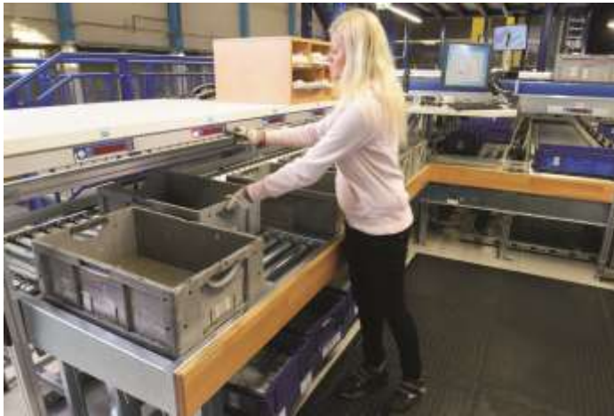
Pick-by-Light-Anlage von Aberle Logistics für die Behälterkommissionierung. Die Implementierung erfolgte bei Claas.
