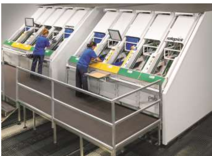
Hochleistungskommissioniersystem Rotapick von PSB Intralogistics. Mit der Anlage kommt ein einziger Kommissionierer auf über 1000 Picks in der Stunde.
