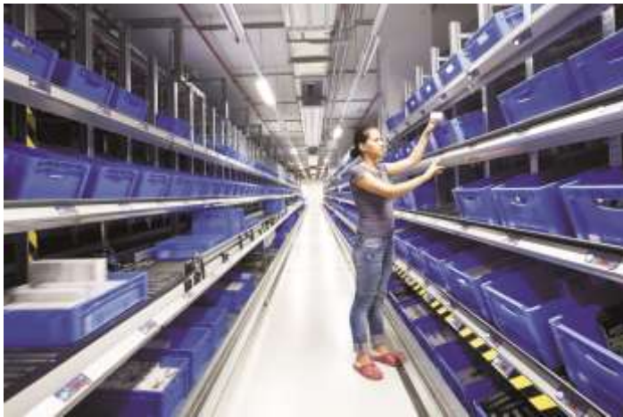
Kommissionieranlage mit Pick-by-Light-Anzeige von Viastore Systems, die bei Bort Medical realisiert wurde
