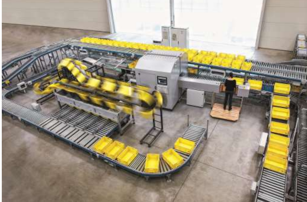
Der Batch-Pick'n-Scan-Sorter von SSI Schäfer stellt eine Anlage dar, die die Kombination von Batch-Picking, Scan und anschließender Sortierung ermöglicht.
