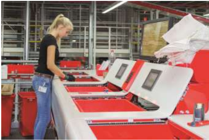
Ergonomische Kommissionierung mit der Kommissionieranlage Pick-it-Easy von Knapp bei Würth in Künzelsau.
